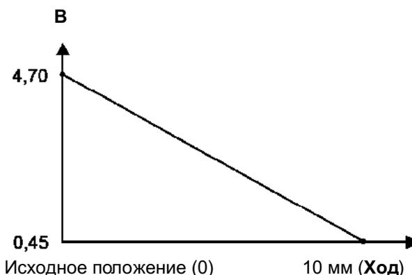
Предварительно убедитесь в том, что на датчик поступает напряжение **+ 5 В**, не разъединяя разъем датчика.
