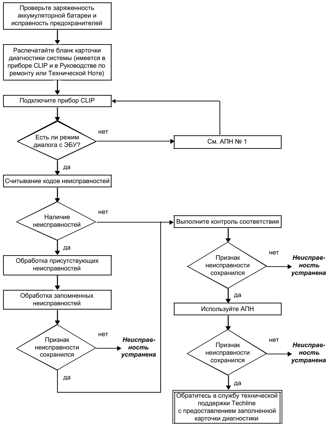
**4. ОБЩАЯ СХЕМА ПРОВЕДЕНИЯ ДИАГНОСТИКИ (продолжение)****Проверка электропроводки****Трудности при диагностике**
