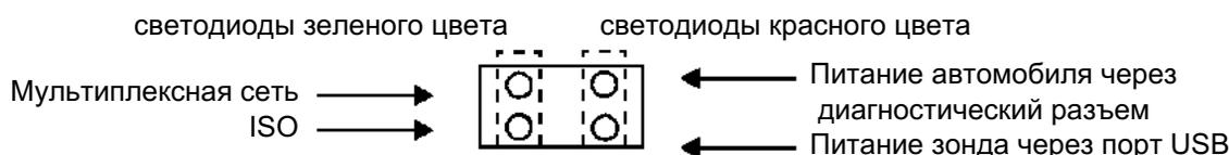
Проверьте наличие на следующих контактах диагностического разъема:
